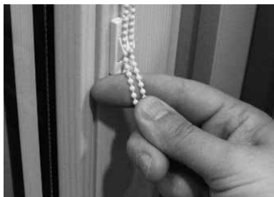
1. Zum Heben, Senken oder Wenden der Jalousie die Kugelschleife aus der Kettenhalterung lösen.
